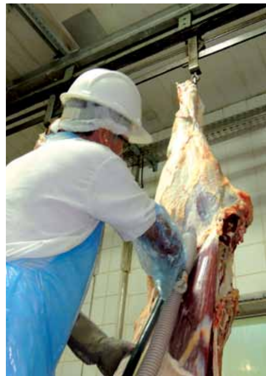
Equipamento usado para sugar resíduos (acima) facilita limpeza da carcaça. Durante o processo, são retiradas também as contusões, graves ou leves, como na foto.
